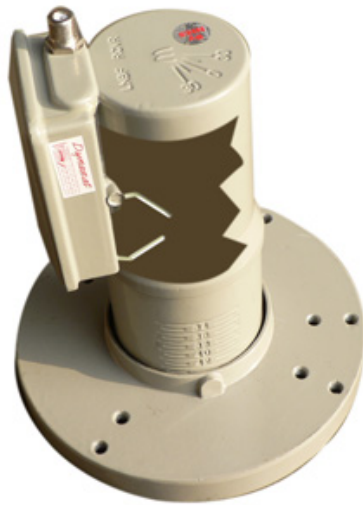
รูปที่ 8 แนวเลข 0 กับชี้วงเสอากาศของ LNB ( ฝ่าให้ดูภายใน )
